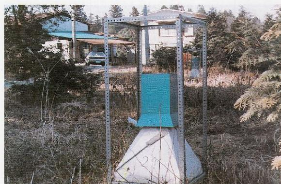
▲上はシンチレータと格納箱及び光電子増倍管信号処理回路。下は上記の写真の装置を設置した状態です（この形のものが100個ほど100m×50m四方の所に置いてあります）
